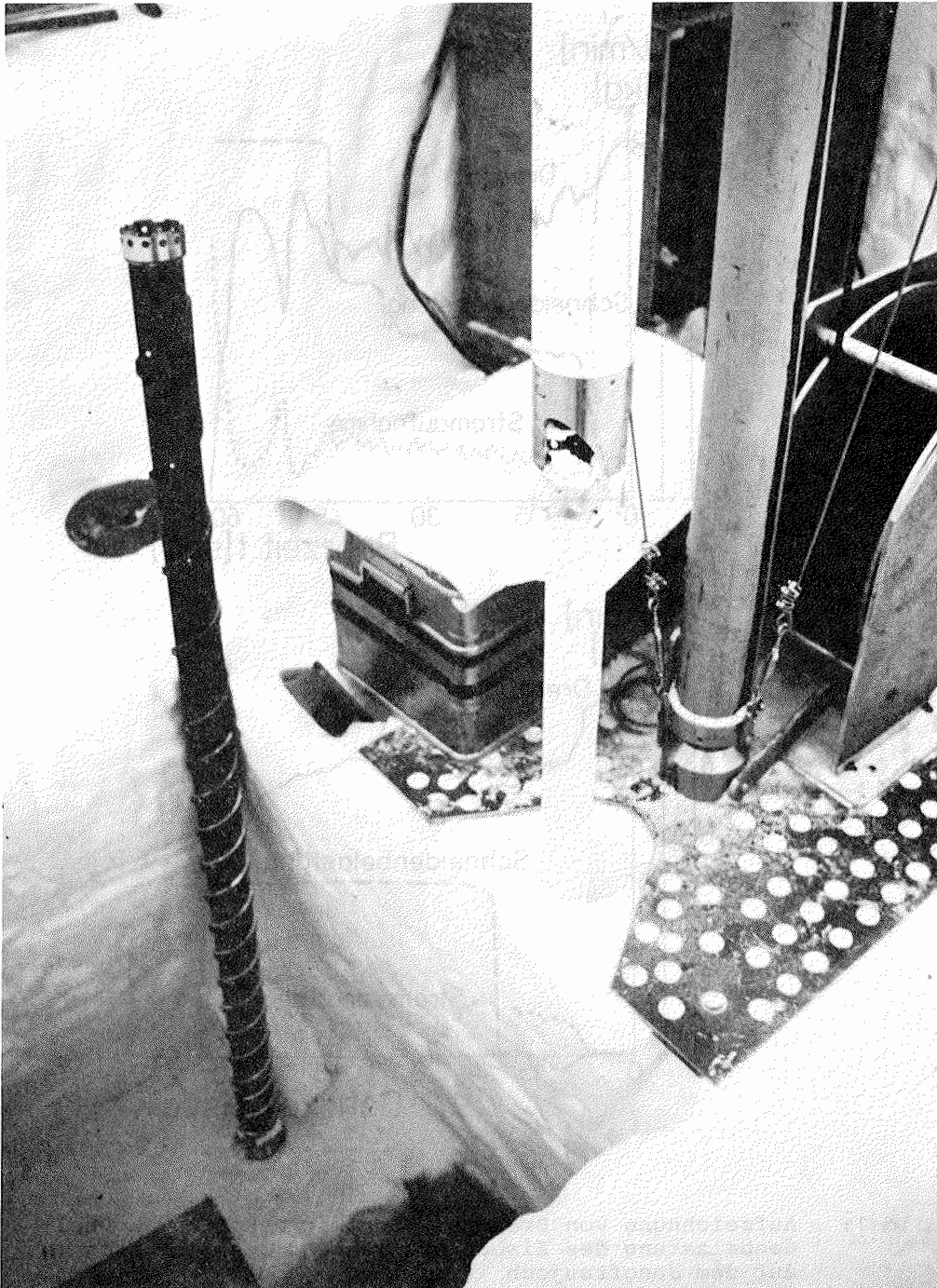
Bild 2: Eisbohrer im Einsatz auf dem Filchner-Eis
