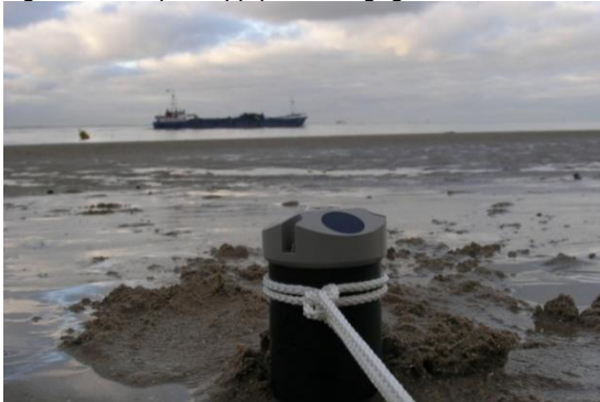
Figuur 4.7 AquaDopp profiler ingegraven in zand van het badstrand Vlissingen (foto M. Schroevers)
