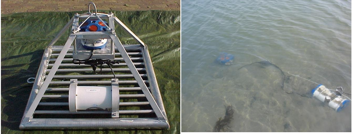
Figuur 4.6 TRDI ADCP en batterijhouder op frame (links) en ingegraven in zand. Foto's RWS Zee en Delta.
