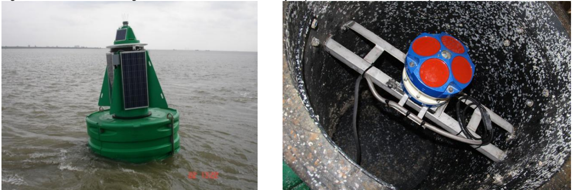
Figuur 4.8 Holle markeringsboei met ADCP aan binnenzijde (foto's RWS Zee en Delta)
