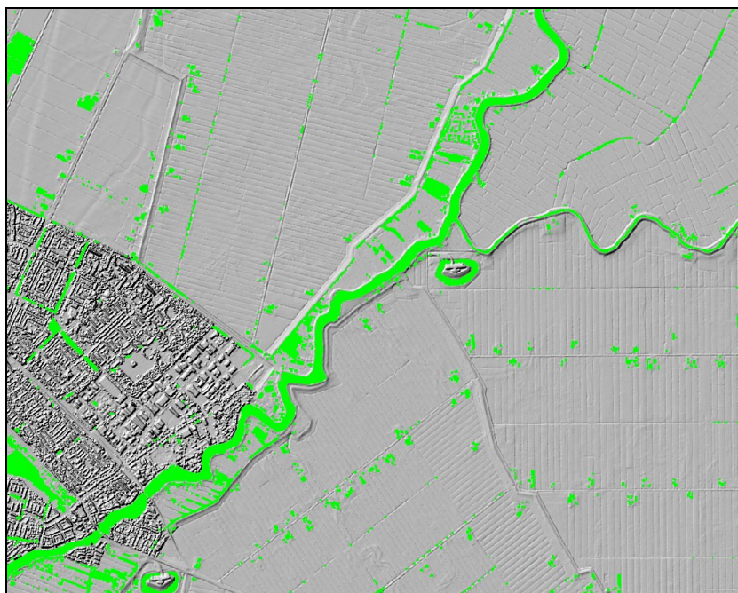
Figuur 5.2b: Voorbeeld van een gefilterde hillshade met het azimuth parallel aan de stroomrichting.
