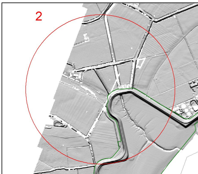
Figuur 8.5c: Detail van locatie 2 van ontbrekende data door uitvallen van de scanner in het projectgebied Westerschelde.
