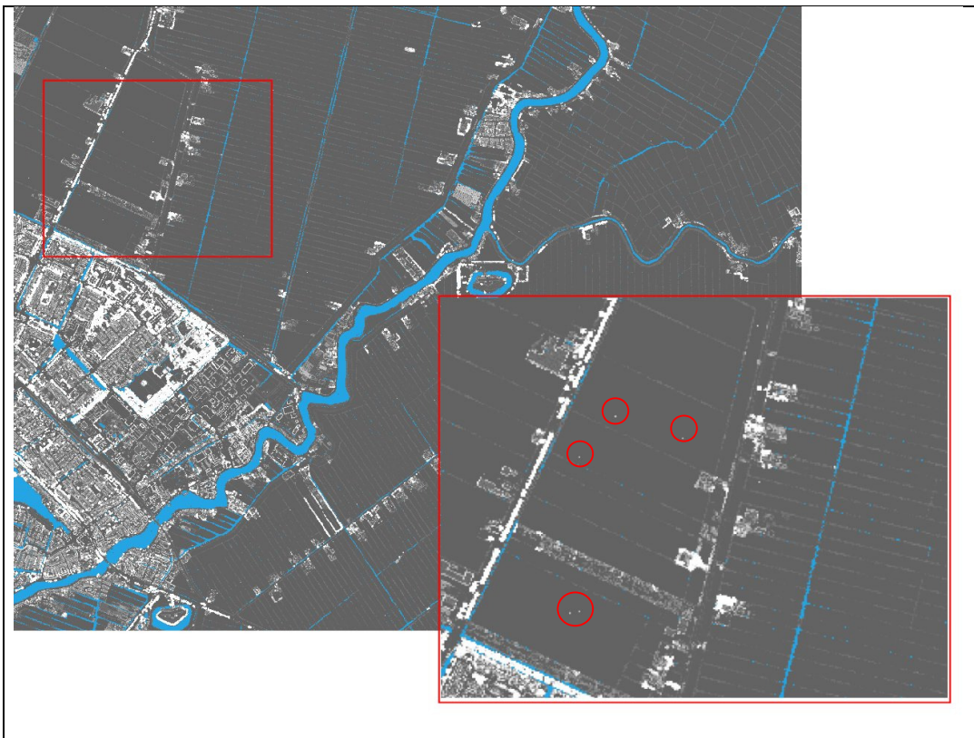
Figuur 4.7: Voorbeeld van een RMS grid met een detail waarin uitschieterende waarden duidelijk als witte puntjes in een egaal grijze ondergrond te zien zijn.
