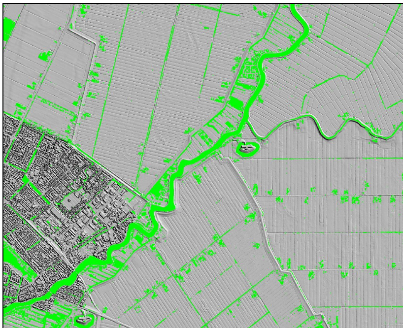
Figuur 5.2a: Voorbeeld van een gefilterde hillshade met het azimuth haaks op de stroomrichting.
