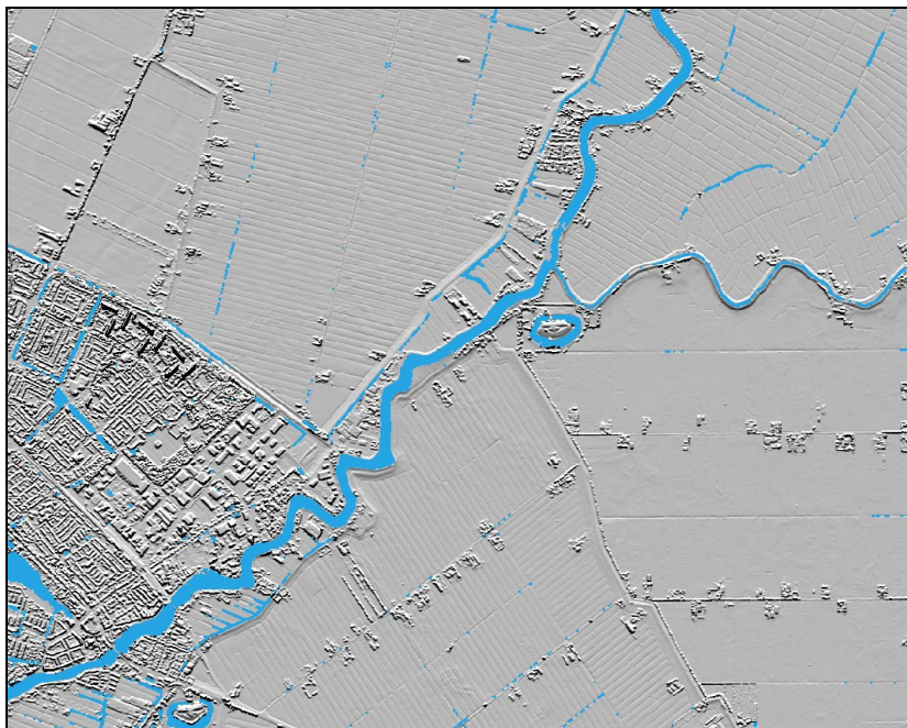
Figuur 4.5a: Voorbeeld van een ruwe hillshade met het azimut haaks op de stroomrichting.
