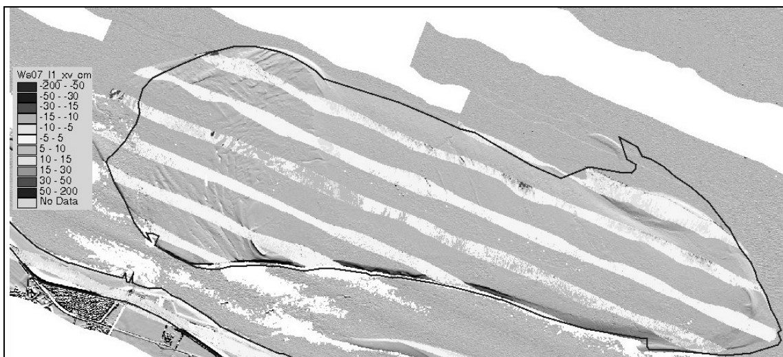
Figuur 3.4: Afbeelding van een voorbeeld hoogteverschilplot met resultaten hoogteverschillen. Afgebeeld is een onderdeel van de Hogeplaten bij Breskens.
