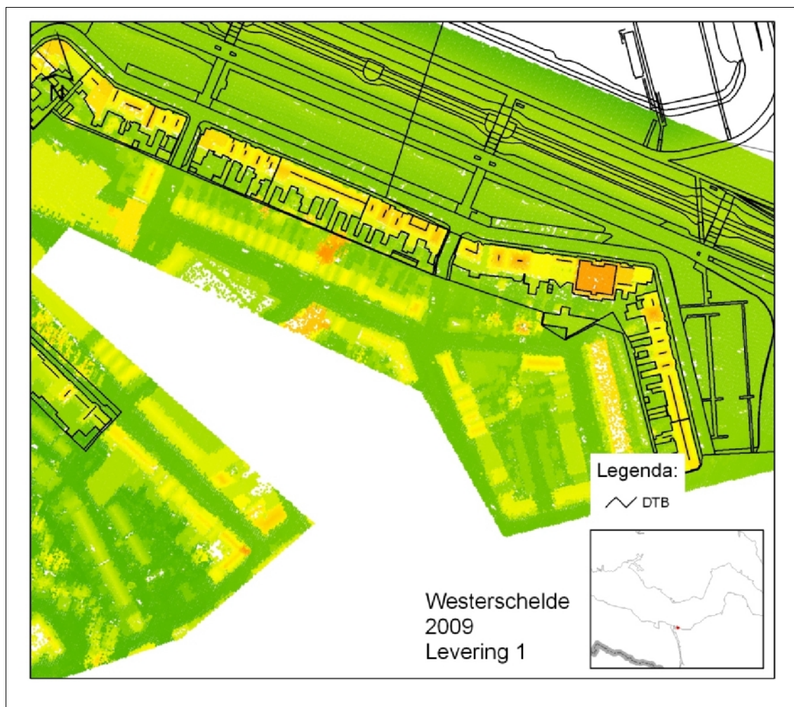
Figuur 3.6: Planimetrie- controle van de puntenwolk vergeleken met het DTB-lijnenbestand.
