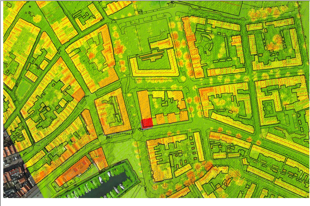
Figuur 3.6: De planimetrie controle is uitgevoerd d.m.v. vergelijking met dtb-lijnen.
