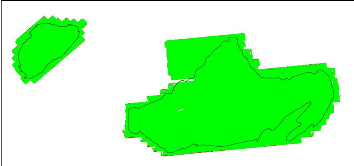
Figuur 8.4a: Overzicht van de punt dichtheid van de laserhoogtedata van het projectgebied Kust 2004, het deelgebied Wadplaten, vóór filtering. Groen betekent voldoende punt dichtheid, rood betekent onvoldoende punt dichtheid.
