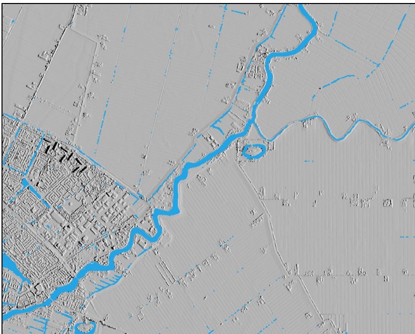
Figuur 4.5b: Voorbeeld van een ruwe hillshade met het azimut parallel aan de stroomrichting.
