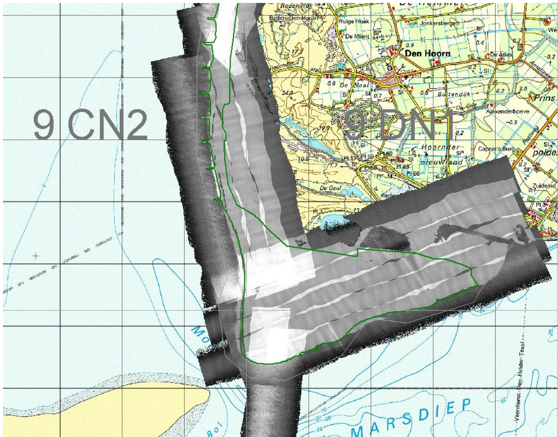
Figuur 8.3b: Detail van de frequentie van de laserhoogtedata van het projectgebied Kust 2004, vóór filtering. Op de ondergrond is TOP50raster afgebeeld. Het betreft het deelgebied Holland (Texel).
