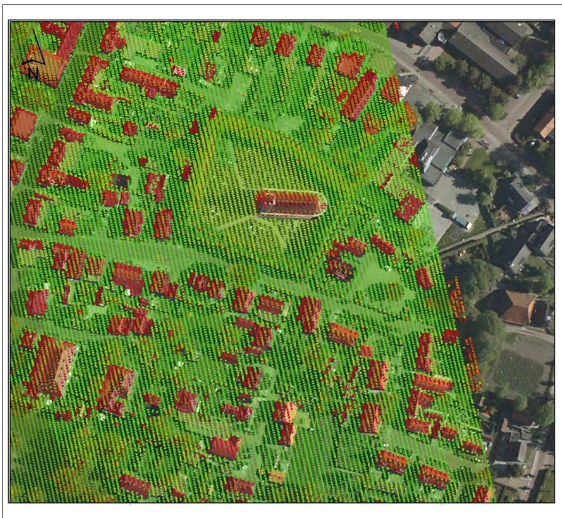
Figuur 3.7a: Planimetrie controle van de laserdata m.b.v. lijnen uit GBKN-data en Luchtfoto.
