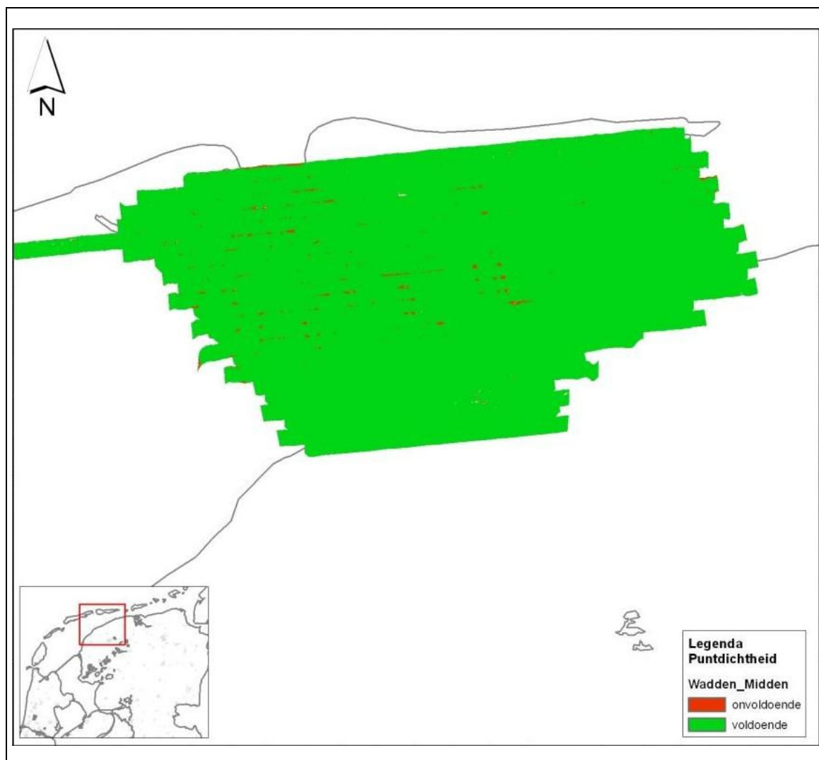
Figuur 3.4a: Overzicht van de punt dichtheid van de laserhoogtedata van het projectgebied Wadden Midden.
