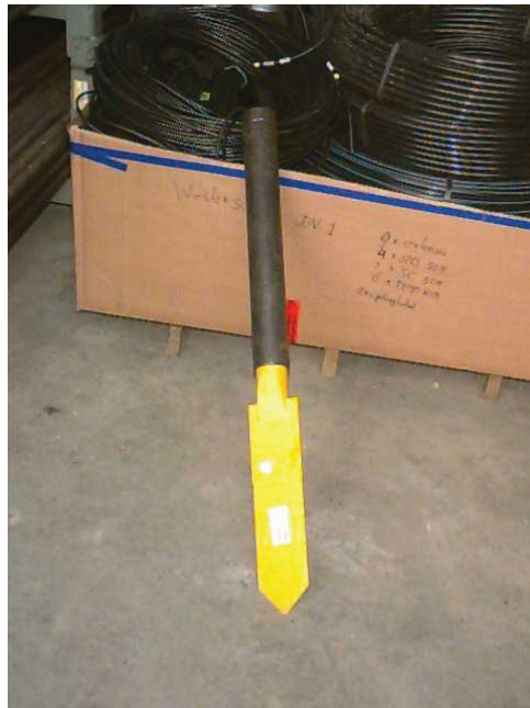
Figuur 6.6 links: Spade Cell; het ronde witte stipje is de waterspanningsmeter en in de witte rechthoek wordt de gronddruk gemeten.
