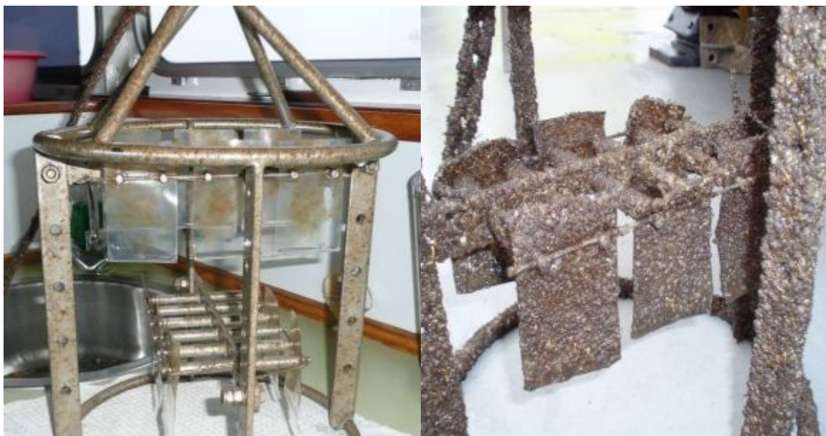
Foto 5.1 Passive samplers na blootstelling. Links nauwelijks, en rechts stevig begroeid.
