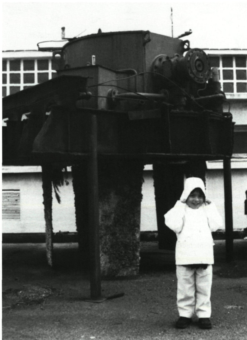
Photo récente, prise à Dunkerque, d'un propulseur Voith-Schneider. Pour vous rendre compte de la taille, Marie, 3 ans, la muse de l'auteur fait une jauge idéale. Sur les pales du propulseur, vous remarquerez les balanes qui les recouvrent presque uniformément.
