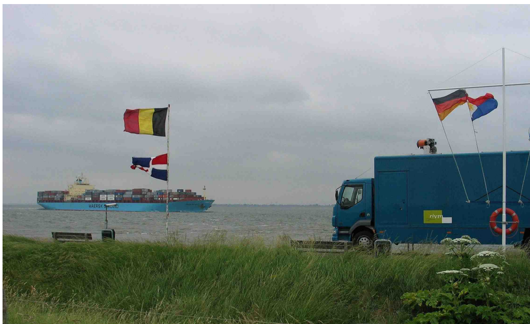
Figuur 6: Zwaveldioxidemetingen met de Lidar bij Hansweert.
