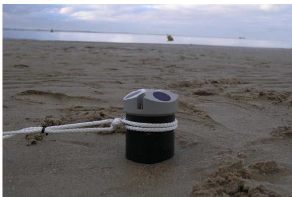
Figuur 4.9 Aqua Dopp Profiler ingegraven in het zand.
