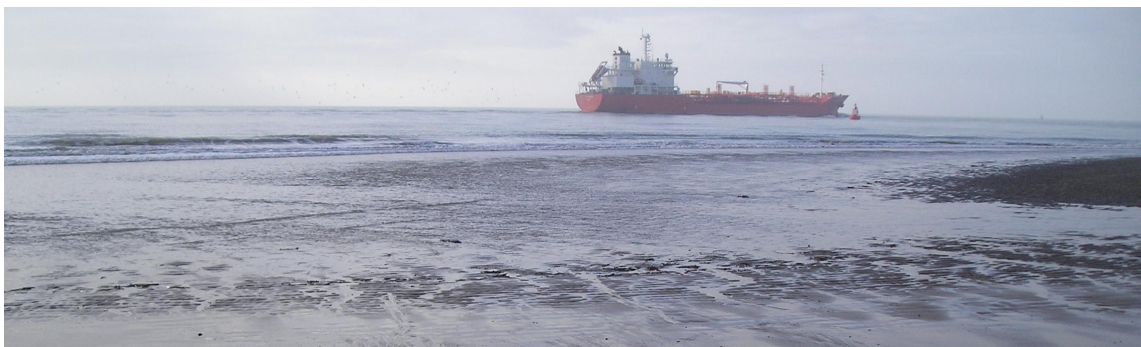
Figuur 6.35 Passage van de UCT Everad, event 19, de waterspiegeldaling bereikt het strand tijdens laagwater.
