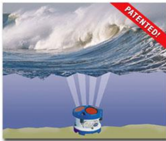
Figuur 4.2 Artistieke impressie van het meten van golven met een ADCP. Bron: Teledyne RD Instrument.
