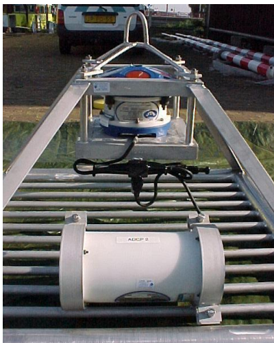
Figuur 4.1 Een ADCP en batterijhouder in een meetframe van RWS dienst Zeeland.
