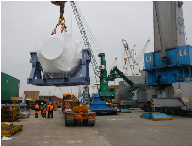
Foto's 4-6: Transport van een windturbine-onderdeel van 80 ton in de Antwerpse haven (bron: ZF Wind Power)
