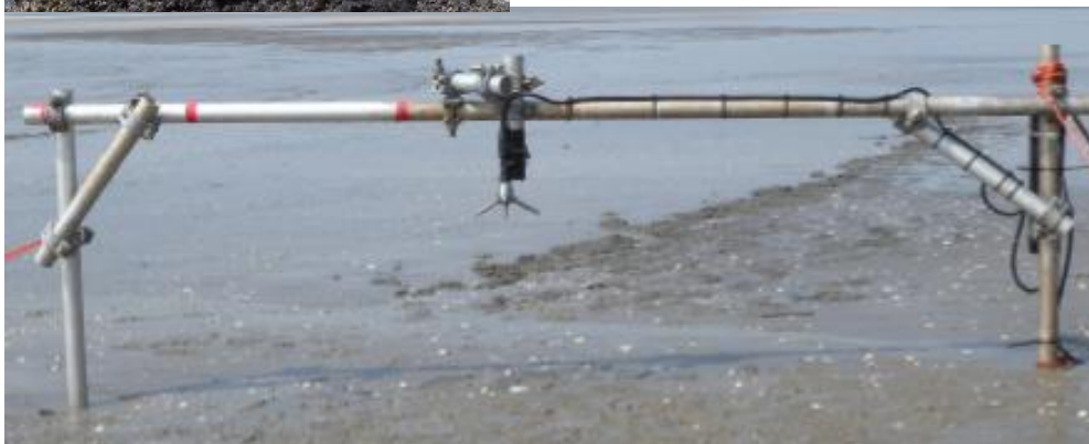
Figuur 3.2 VECTOR (midden ADV en rechts achter paal de druk sensor) (referentie: Nortek, 2010).
