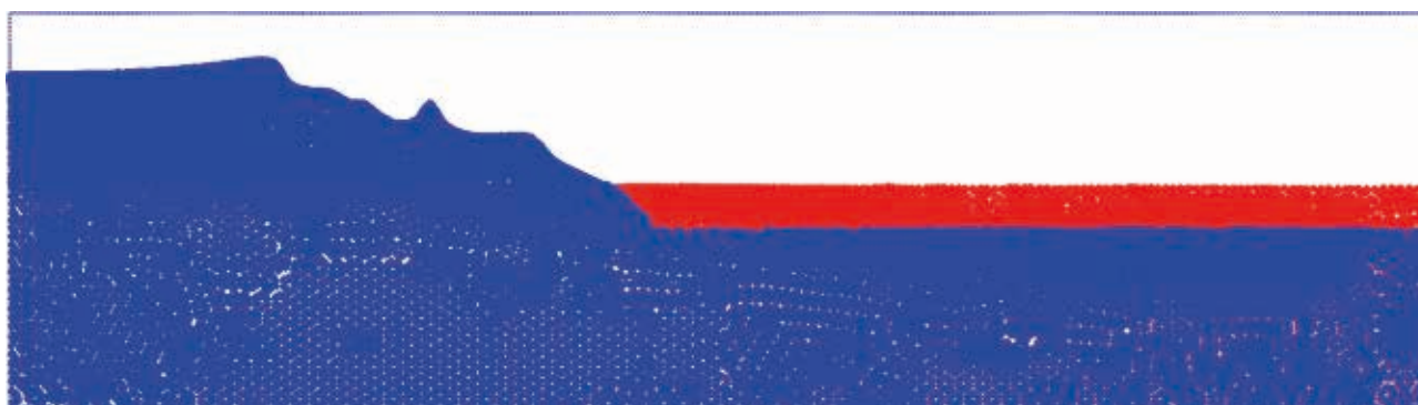
Figuur 3.46 Discretisatie van de materiaalpunten voor en na de onmiddellijke verwijdering van zand.
