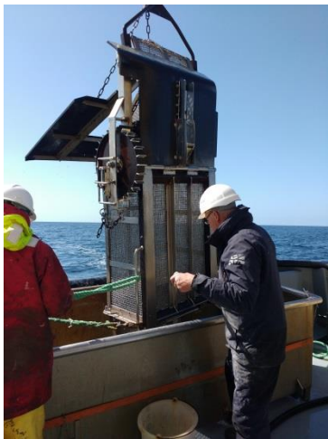
Figuur 1. Monstername met de bodemschaaf aan boord van de ISIS.
