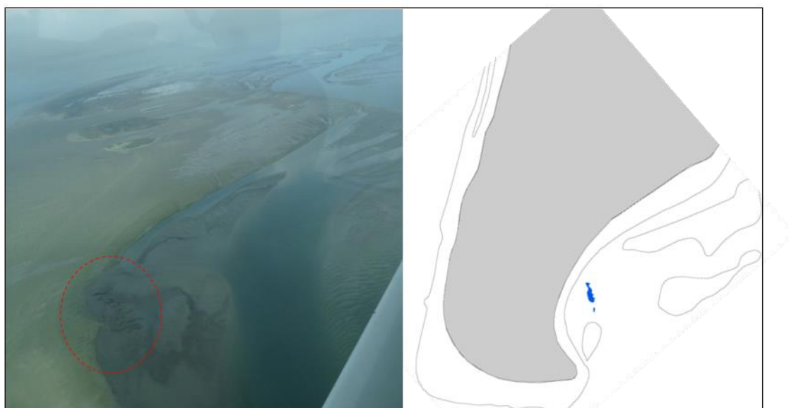
Figuur 2: Illustratie van hoe mosselbanken er uit zien vanuit de lucht, en hoe zich dat vervolgens vertaalt, na inmeten in het veld, naar een ingetekende contour. Links, rood omcirkeld, de structuur die vanuit de lucht tijdens de inspectievlucht is waargenomen in de kom van de Vliehors nabij Vlieland. Rechts in blauw de contour van de mosselbank ingetekend met behulp van ArcMap na het inmeten met de hand GPS in het veld. Merk ook de donkere plekken rechts van de bank op, suggererend dat hier ook mosselen liggen. Bij de inventarisatie te voet bleek het hier om zandkokerwormen te gaan.
