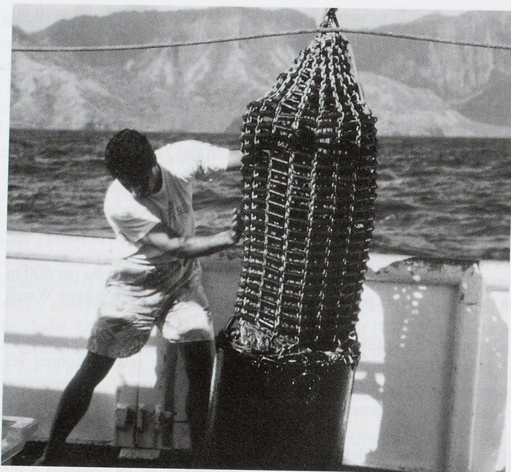
FIG. 5. — La drague à roches (DR) est vidée sur le pont au large de Nuku Hiva (photo P. LABOUTE).
