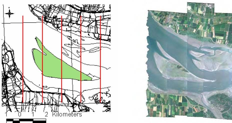
Figuur 9a. Geplande vluchtlijnen over de Plaat van Walsoorden (links) en b. quicklook van het CASI III beeld van 30 juni 2006 (rechts).
