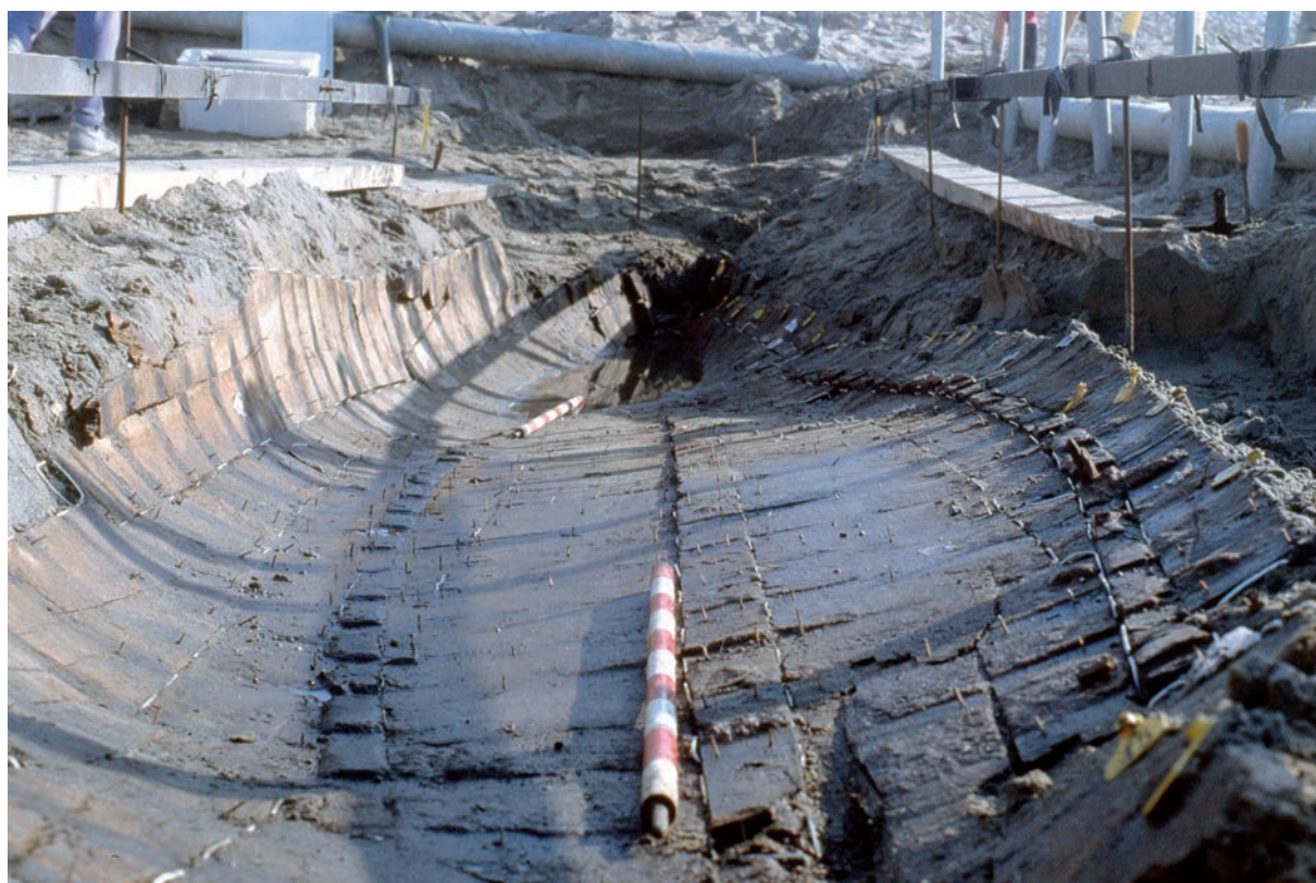
Figura 2. Vista del casco sin cuadernas, con la popa al fondo. Se puede apreciar la «tabla de quilla» en el centro y los carenotes endentados a ambos lados (Albert Martín i Menéndez).
