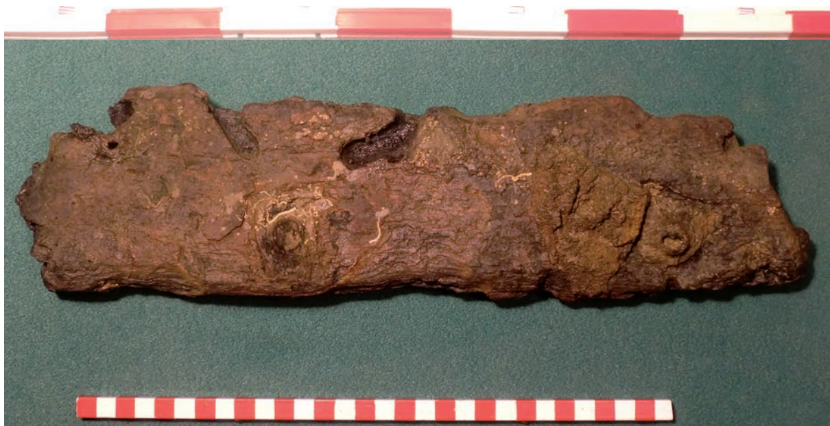
Figura 1. Detalle de las improntas de las arandelas rectangulares del T-11.
