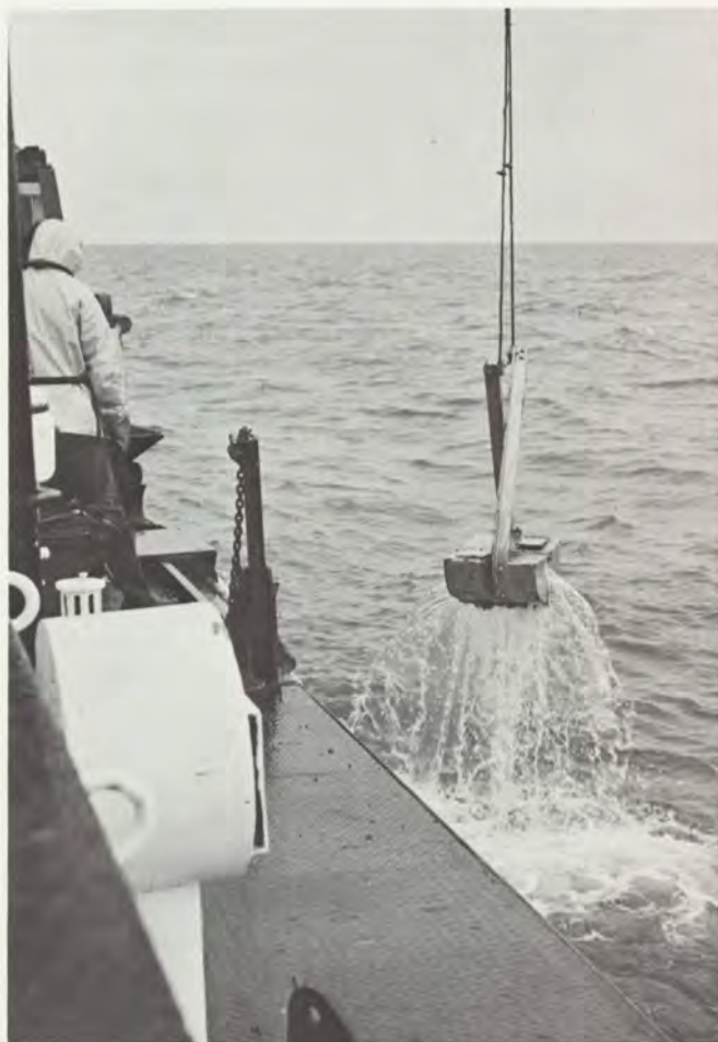
Een „Van Veen“ happer, voor het nemen van bodemonsters, in gebruik. (foto: Directie Noordzee)
