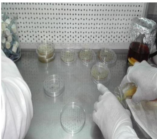
Figura 16 Siembra de las muestras por la Técnica ISO 9308-1 vertido en placa
