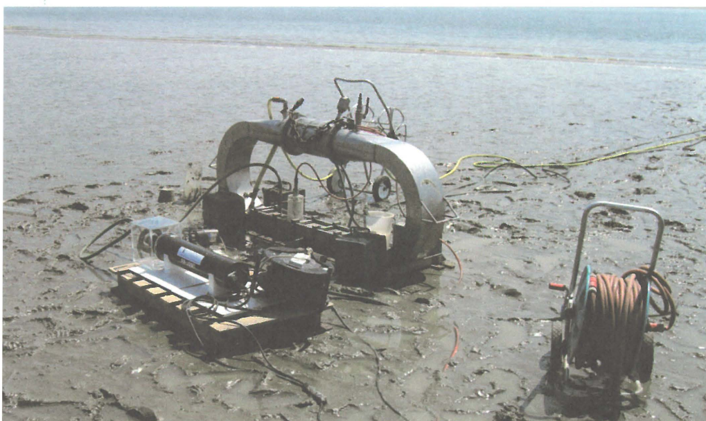
Veldwerk in de IJzermonding met een Global Positioning System (GPS) en een 'Analytical Spectral Device' (ASD) (boven). Op de Molenplaat in de Westerschelde wordt gewerkt met de Laser In-Situ Scattering and Transmissometry (LISST) en een In-Situ Erosion Flume (ISEF) (midden en onder) (LH)
