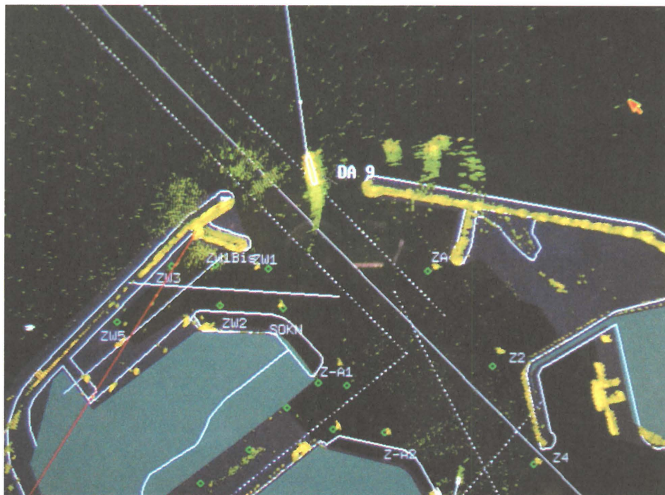
De verkeerscentrale op de westelijke strekdam van de haven van Zeebrugge begeleidt de scheepvaart op de maritieme toegangswegen naar de Vlaamse kusthavens en naar de monding van de Schelde. Op het scherm kunnen alle scheepsmanoeuvres gevolgd worden; hier een schip die de haven wil uitvaren in Noordelijke richting (SVB)
