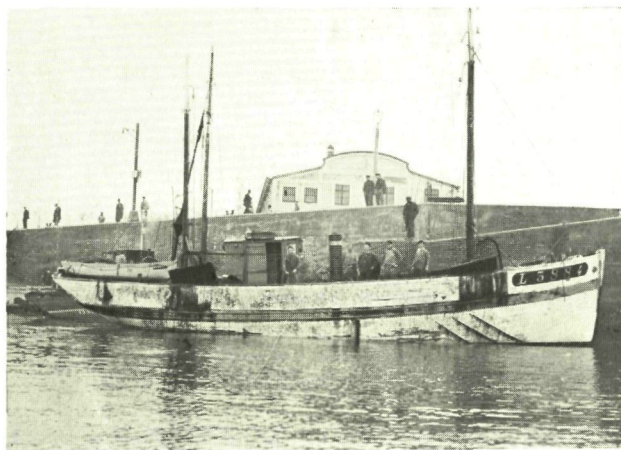
Fig. 28. Pinasse de 20 tonneaux à moteur de 40 C. V. utilisant le chalut à plateaux.
