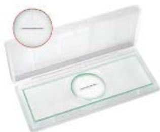
Figure 2 : Image d'une lame micromètre étalon
