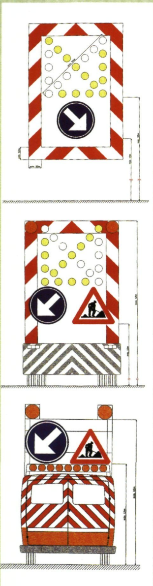
Signalisatiepanelen voor: • wegen met afgesloten linker rijstrook • eerste hinderend voertuig op autosnelwegen • met minder dan twee rijstroken per rijrichting
