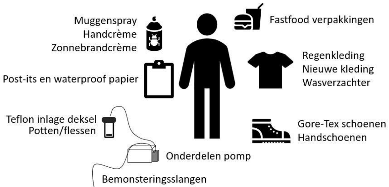
Figuur 15 Mogelijke oorzaken van contaminatie van het monstermateriaal tijdens bemonstering
