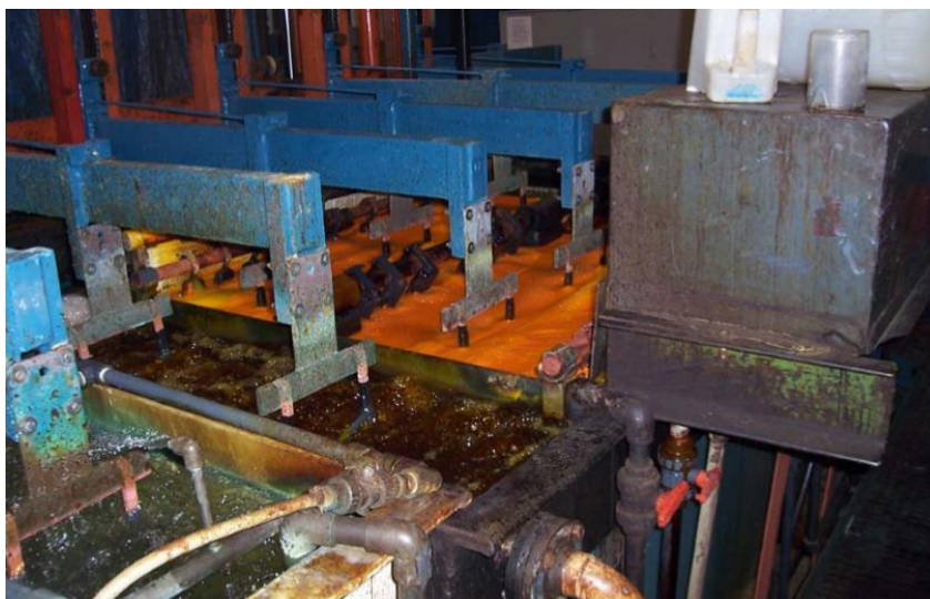
Figuur 9 Verchromingsbad (met oranje schuim) met spoelbaden (EPA, 2009)
