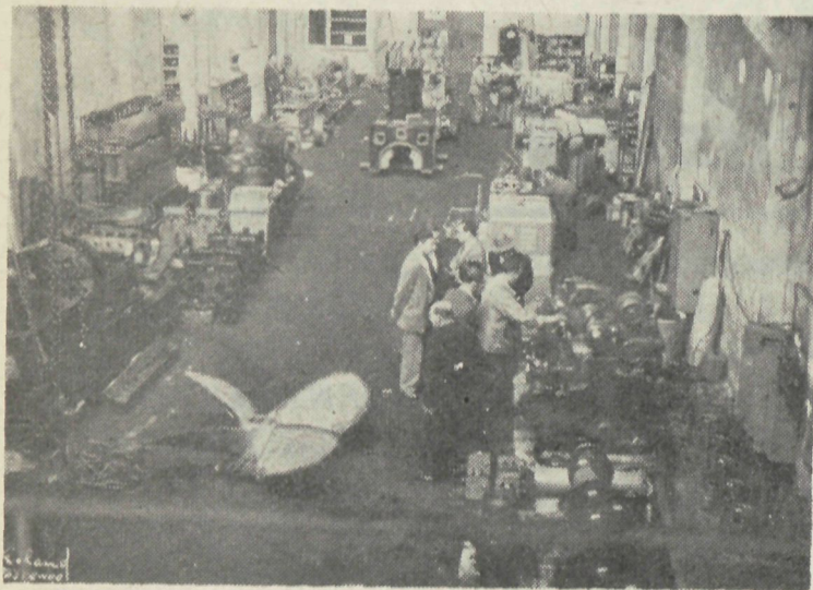
Een beeld van het enorme werkhuys «Valcke» nabij de Vissershaven waar de motoren Deutz worden hersteld of vernieuwd.
