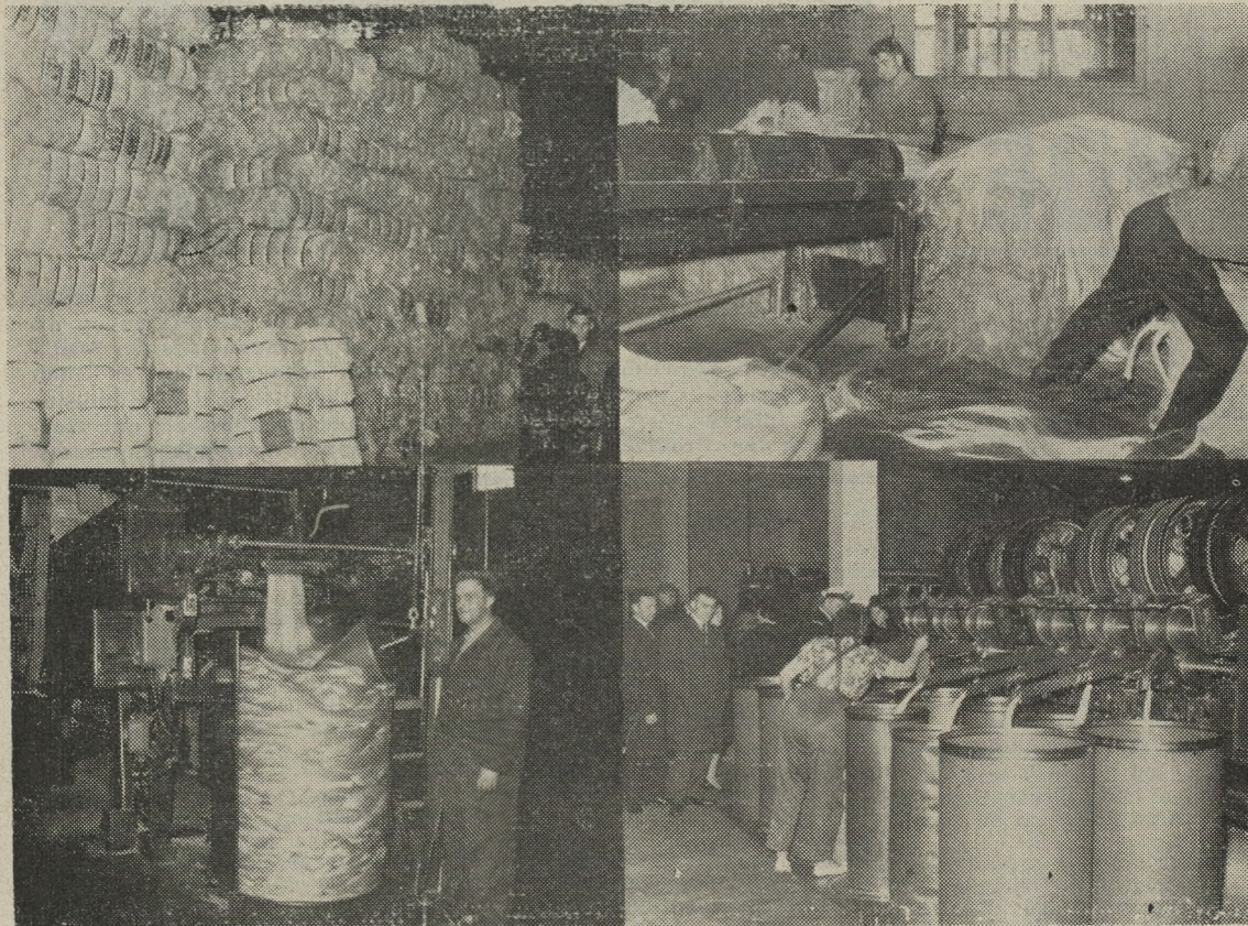
Enkele hoekjes van de werkelijk zeer grote fabriek, die te Oostende haar deuren opende. 1. Een deeltje van de reusachtige stapelplaats voor ruwe vezels. 2,3 en 4 : enkele fazen der verschillende bewerkingen. Aan een ongelooflijke snelheid wandelen de vezels van machine tot machine, worden gemengd, gesponnen, uitgerokken tot eindelijk het harde sterke touw « wereldmarkt klaar » de fabriek zal verlaten. Produktie op heden : 30 Ton per dag !
