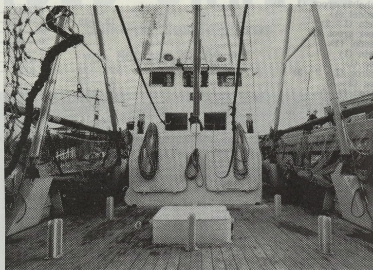
Enmaal de korre aan boord kan de verdere bewerking van de vangst geschieden op een zeer ruim en obstakelvrij werkdek, essentiële voorwaarden voor een vlot verloop.
