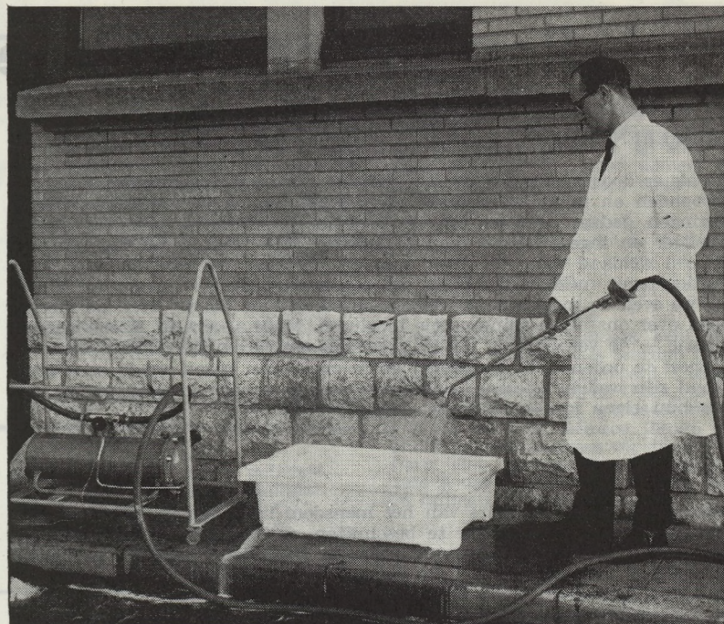
Fig. 4. — Desinfectie-apparaat met automatische toevoer en drukregeling
