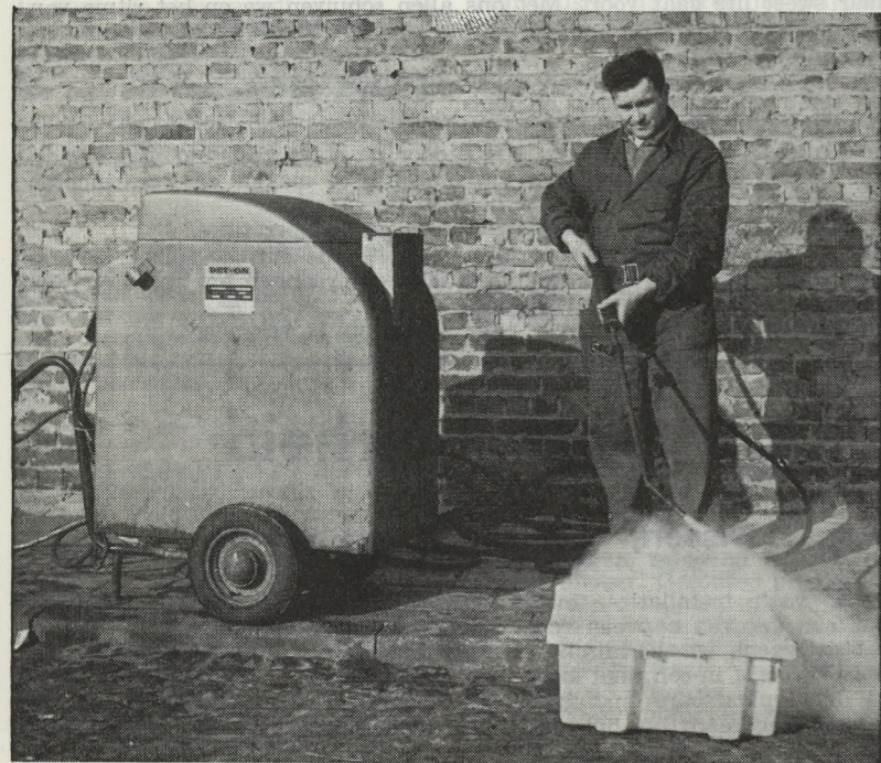
Fig. 3. — Stoomreinigen met automatische detergenstoevoer
