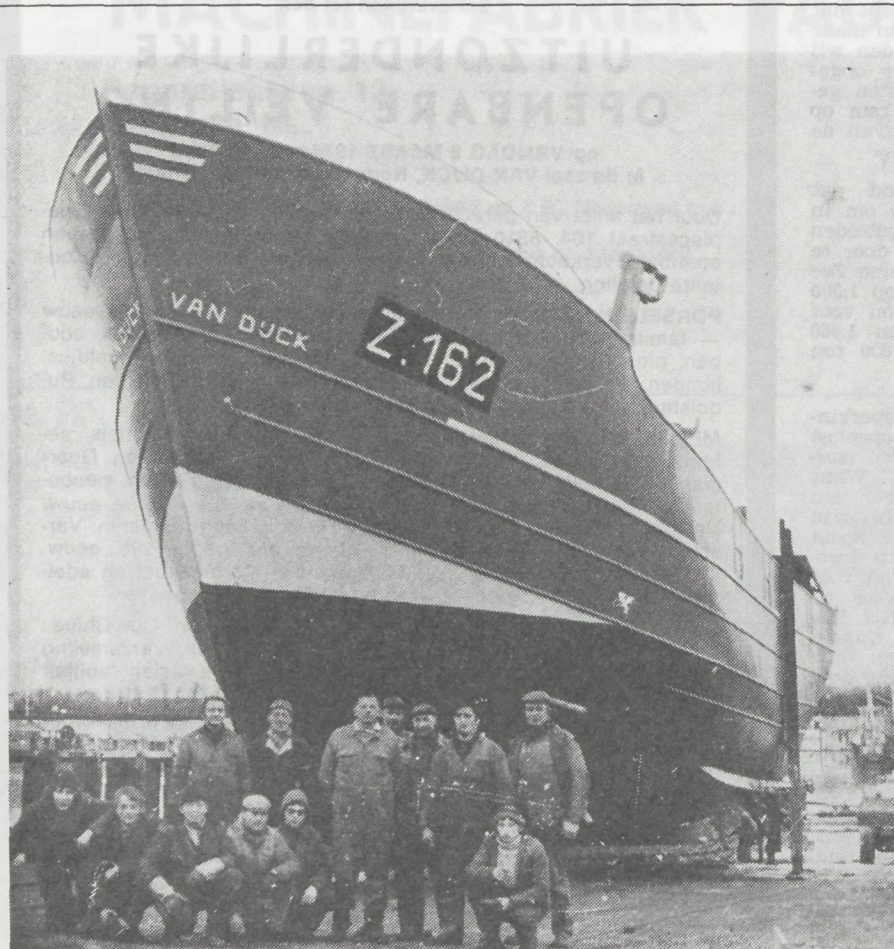
In de vissershaven van Zeebrugge werd de Z.162 Van Dijk te water gelaten. Dit schip werd gebouwd op de scheepswerf van Leon De Graeve voor rekening van reder Leon Gezelle uit Zeebrugge. Deze stalen treiler met een lengte van 34 m., wordt uitgerust met een MAK-motor van 1.000 PK. De doop van de Z.162 zal vermoedelijk plaatsgrijpen in de maand mei. (Foto R. Claeys - N.v.d.K.)
