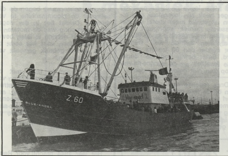
De Z.60 „Blue Angel”, gebouwd op de Scheepswerven Leon De Graeve, eigenaar Rederij Couwzyer, vaart met een F.240 dieselmotor van 1.000 PK bij 750 omw./min.
