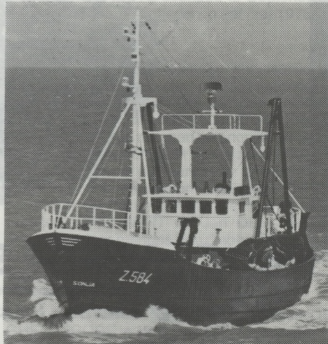
Het tweede schip van André Vantorre, de stalen middenslagtreiler Z.584 die in 1967 werd gebouwd op de Scheepswerven Degraeve.
