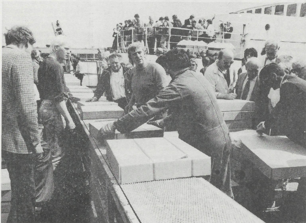
In kartonnen dozen, met een inhoud van veertig kilogram per doos, worden de kantjes uit de ruimen van de SCH.108 gehaald en via een transportband naar de wal gebracht.
