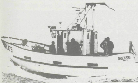
Een pleziervaartuig dat aangepast is voor bepaalde visserijen. Vooraan merkt men een lierinstallatie.
