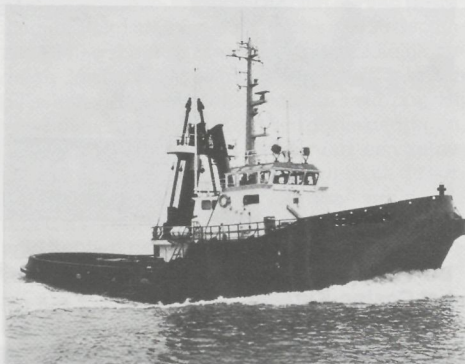
De sleepboot „Sea Horse” van de Unie van Redding- en Sleepdienst. Een Deutzmotor, type SBV12M628 geeft deze eenheid een vermogen van 3.000 PK
