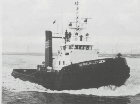
De sleepboot „Nathalie Letzer” van de Unie van Redding- en Sleepdienst. In de motorkamer kloppen twee SBA12M528-Deutzmotoren met een vermogen van 1.200 PK elk.
