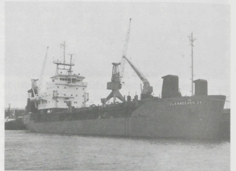
De „Vlaanderen XX”, een baggerboot van de firma Decloedt & Zn, die wordt voortgestuwd door twee Deutzmotoren van het type BV12M540.
