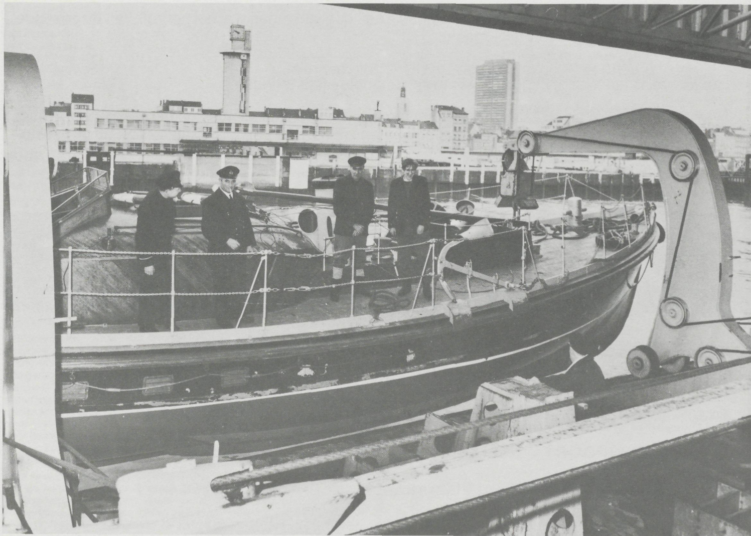
Aan de oostkant van de havengeul, rechtover de „Istanbul” staat nog de reddingsloods waarin de „Watson”-reddingboot in davits opgehangen en geborgen was. Bij „permanentie” wordt de boot te water gelaten en klaargelegd voor aktie.
