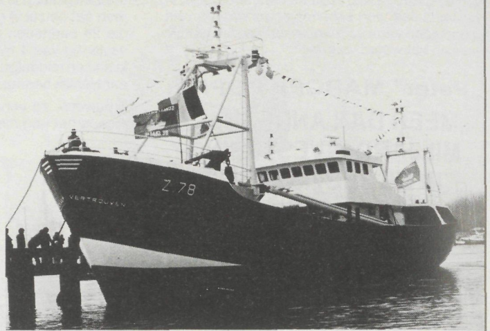
De Z.78, van rederij p.v.b.a. VANTORRE-DOBBELAERE, voortstuwingsinstallatie: 8 cilinder f240, 1.200 pk bij 750 omw/min.
