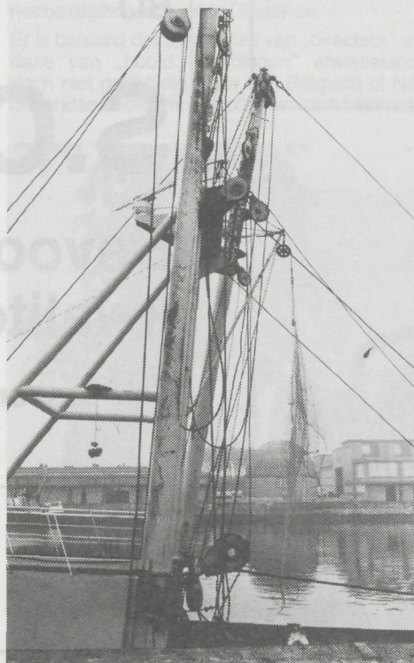
Twee beelden van averij die de Z.185 „Emerald Star” opliep na de aanvaring met de boortoren. Foto links: de voorstevan die onder een lengte van ruim drie meter werd ingedrukt. Foto rechts: de bokkeninstallatie die eveneens zwaar beschadigd werd.
