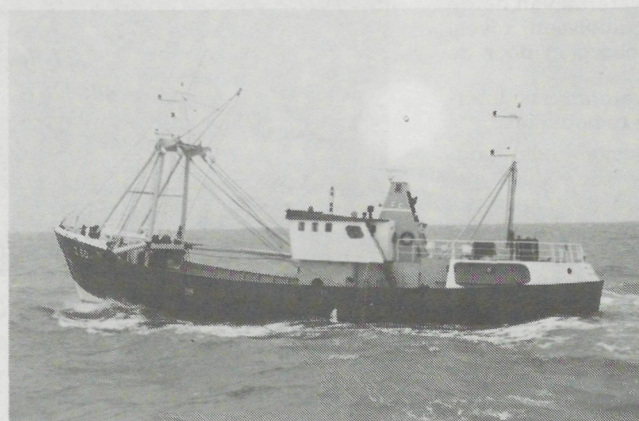
De Zeebrugge 60, Rederij/Eigenaar: C. Kouwijzer, Knokke-Heist. Uitgerust met een 8-cilinder F240 motor van 1.000 pk bij 750 omw/min.
