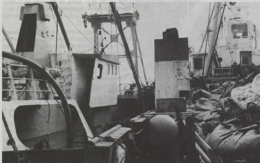
De „Blue Angel“ met de bergingsmaatschappij. Aan boord van de sleepboot bemerkt men de ledige luchtkussens.
