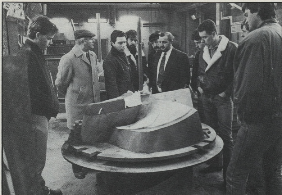
Het maken van de gietvorm in zand volgens plan vraagt een grote vaardigheid. (foto gw)
