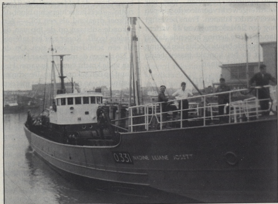
De O.331 'Nadine Liliane Josette': stalenmotortreiler uit 1948 (Boel Temse). 34 meter lang met Carelsdiesel van 300 pk. In 1974 verkocht aan Zeebrugge, waar het werd aangepast aan de bokkenvisserij en nog vele jaren actief was.
