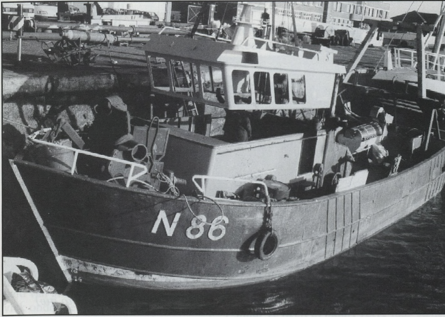
Het nieuwe bovendeel van het stuurhuis wordt aan boord gebracht van de N.86 Surcouf. (foto gw)
