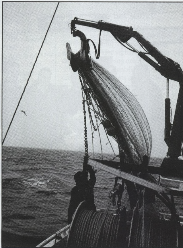
Het net ligt in de powerbloc en wordt op het achterdek getrokken.
