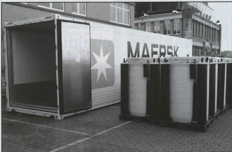
De Maersk-container met daarnaast de acht tanks van 1.200 liter die op het koel- en zuiveringssysteem worden aangesloten (foto gw)
