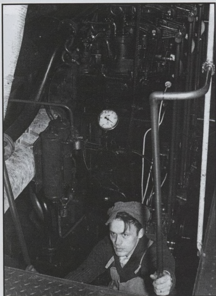
Fernand Weerbrouck bij zijn troetelkind, de traaglopende 300 pk Deutzmotor van de motortreiler O.231 André-Monique.
